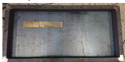
Abbildung 6: Platte (4 mm Dicke) mit Dämpfer im oberen linken Viertel.
